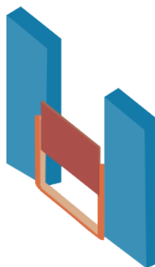
Installation temporaire de batardeaux pour empêcher les eaux de pénétrer
